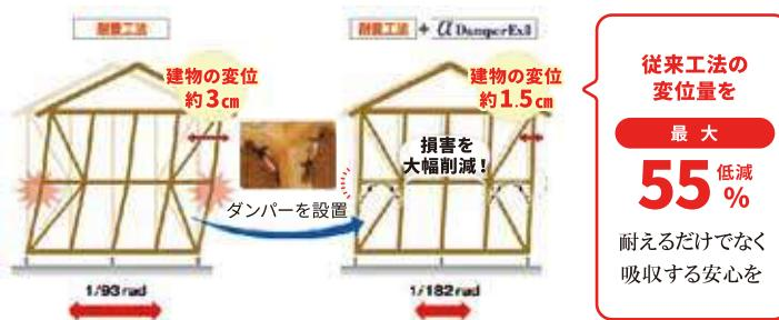
ダンパーを分散配置することで、建物の粘り強さ(減衰力)を高め、繰り返しの地震による耐力の低下を抑制します。メンテナンスフリーで安心の20年製品保証付。
